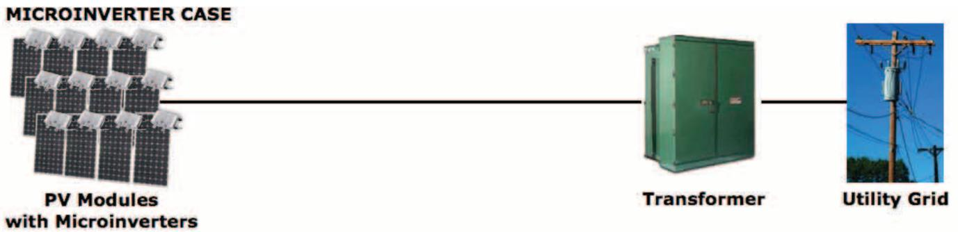
Figure 29. System-Level Inverter Diagram
